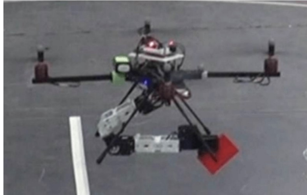
FIGURE 1.8 – Quadricoptère transportant une charge utile à l'aide d'un bras robotique à 2 degrés de liberté avec axes parallèles [12]
