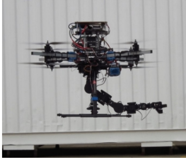
FIGURE 1.7 – Quadricoptère transportant une charge utile via un bras à 6 degrés de liberté [11]
