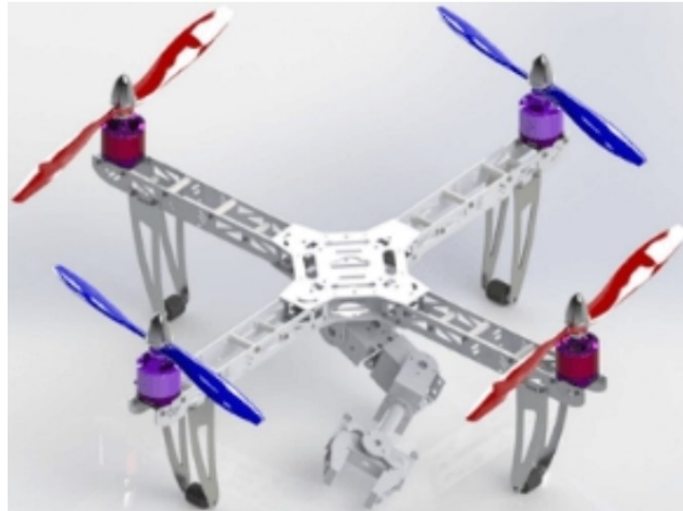
FIGURE 1.9 – Quadricoptère transportant une charge utile via un bras robotique à 2 degrés de liberté doté d'une topologie unique [13]
