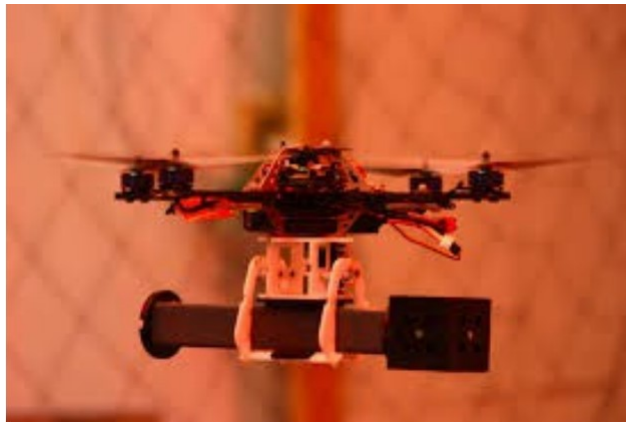
FIGURE 1.3 – Quadricoptère transportant une charge utile via une pince [7]
