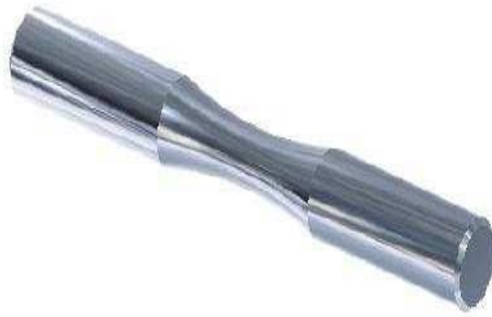
Figure II.12:Éprouvette toroïdale de fatigue
