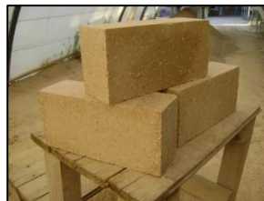
Figure172. Béton de terre stabilisé
