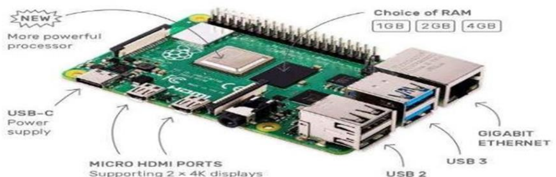
Figure III-2: schéma des ports et composants de la Raspberry Pi [16]
