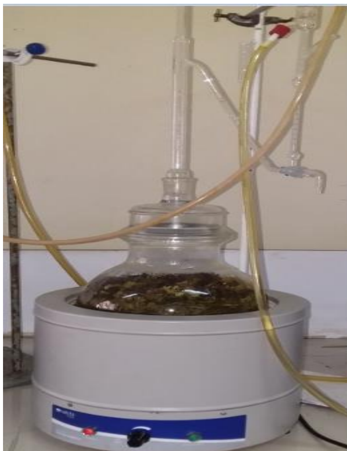
Figure 3: Dispositif d'hydrodistillation utilisé à l'échelle du laboratoire.
