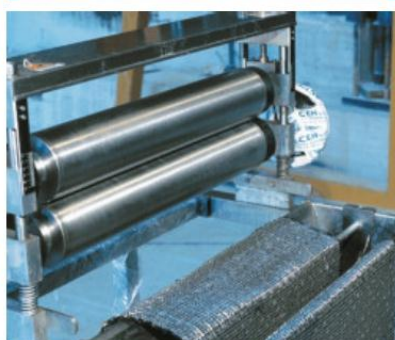
Imprégnation manuelle de MapeWrap C
