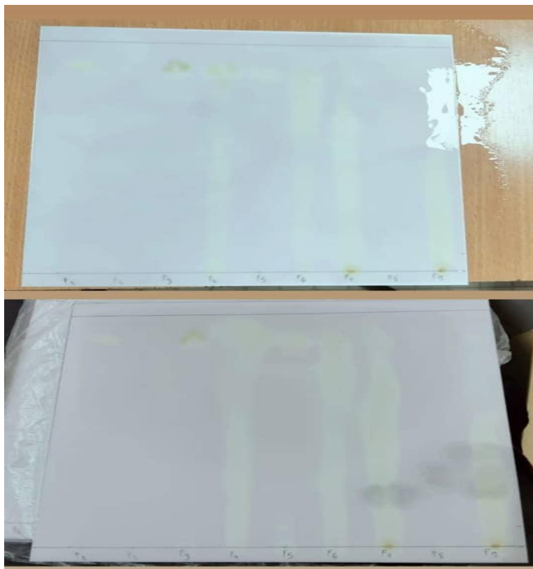
Photo 14: Photographie de la plaque CCM révélée au DPPH.
