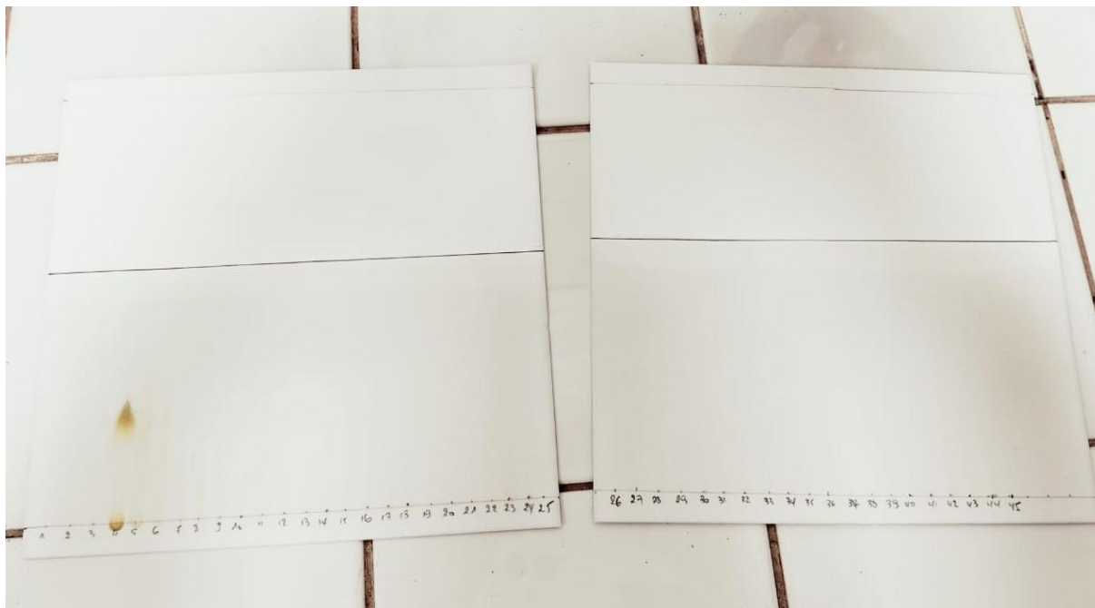
Photo 8: Dépôt de différentes fractions obtenues sur la plaque de CCM.
