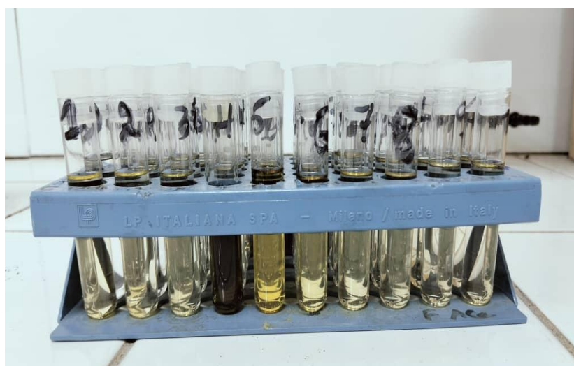
Photo 7: Tubes collectés après séparation chromatographique Sur colonne de l'extrait brut.
