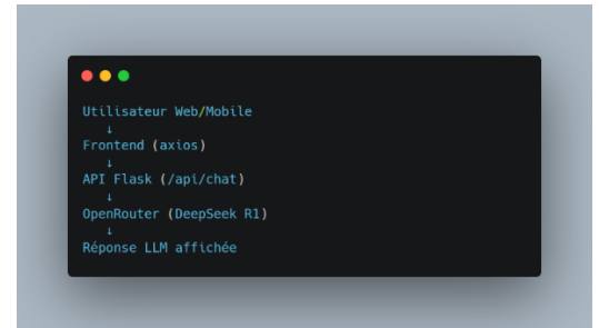
Figure 30 : Architecture d'intégration du LLM
