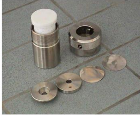
Figure 1.11. Autoclave et ses principaux composants.
