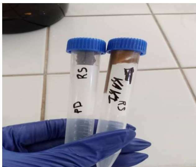
Figure 21: le mélange et la centrifugation d'échantillon pour le dosage des polyphénols (original)
