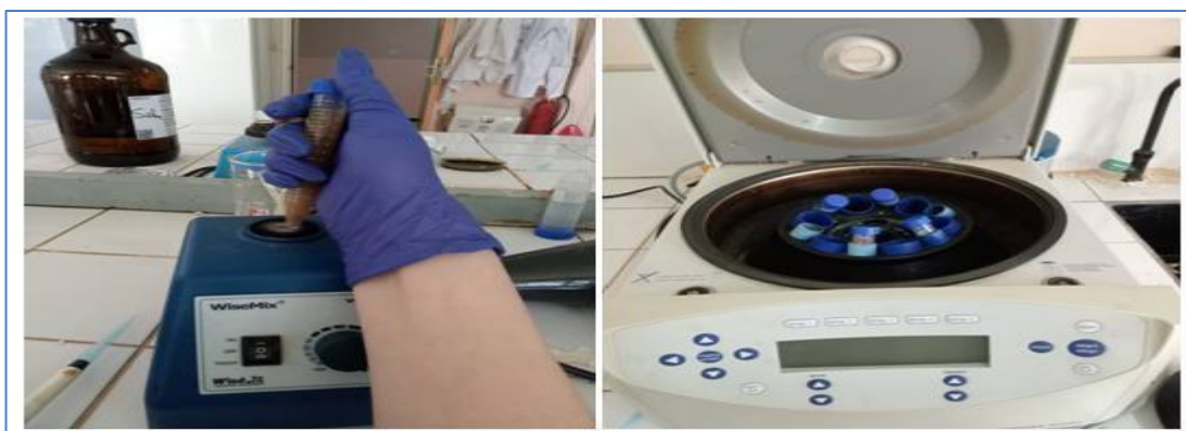
Figure 21: le mélange et la centrifugation d'échantillon pour le dosage des polyphénols (original)
