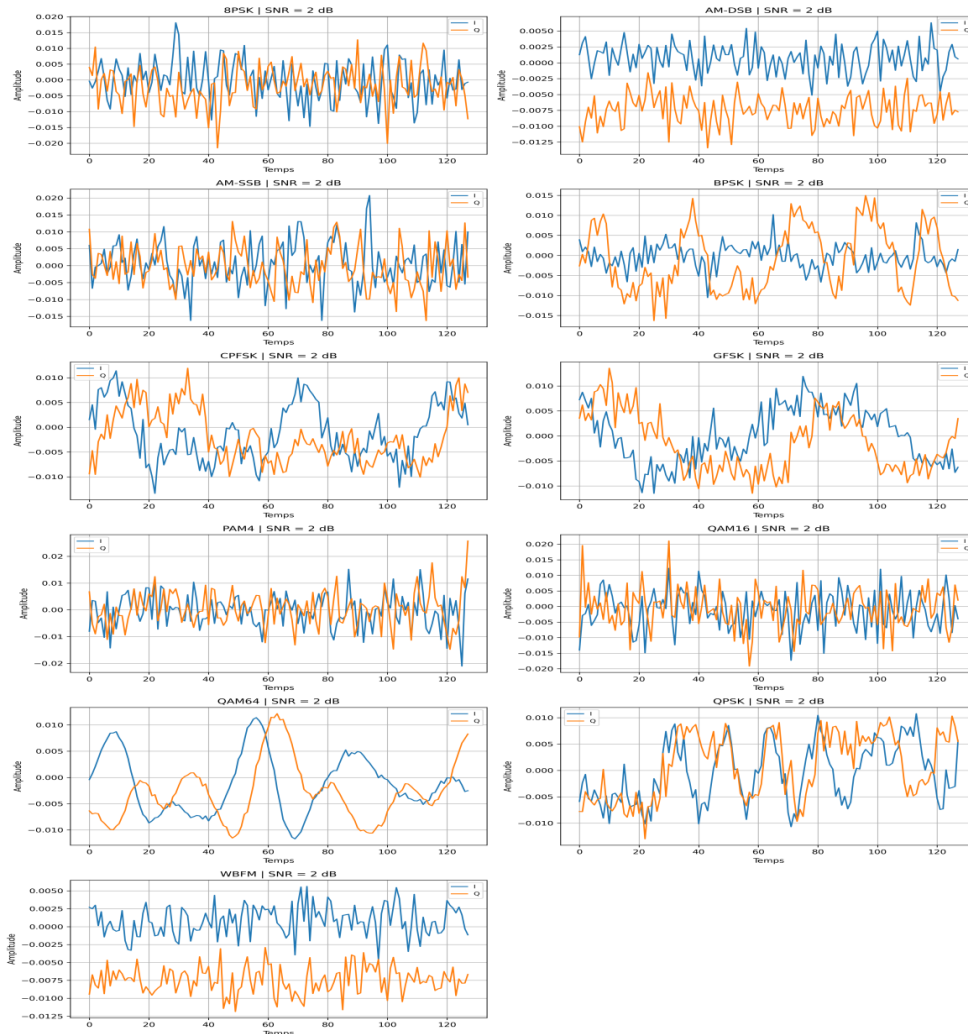
Figure 3.1 : Visualisation des composantes I/Q des modulations RadioML2016.10a à un SNR de 2 dB.
