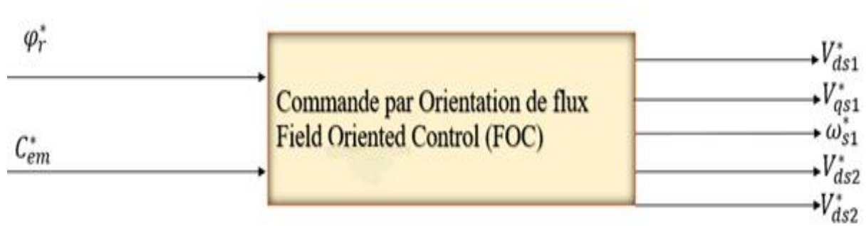
Figure II.11 : Schéma bloc simplifié de la commande à flux orienté (OFR).
