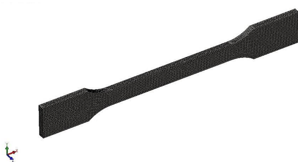
Figure 2.14 Exemple de l'éprouvette avec maillage
