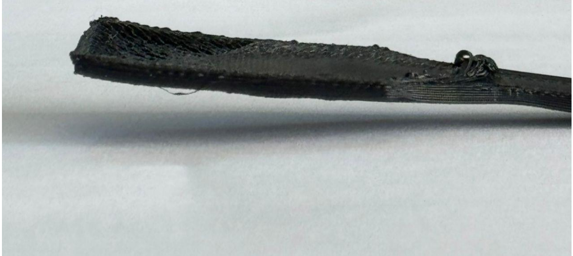
Figure 3.20 Problème d'adhérence lors de l'impression de l'ABS (décollement)
