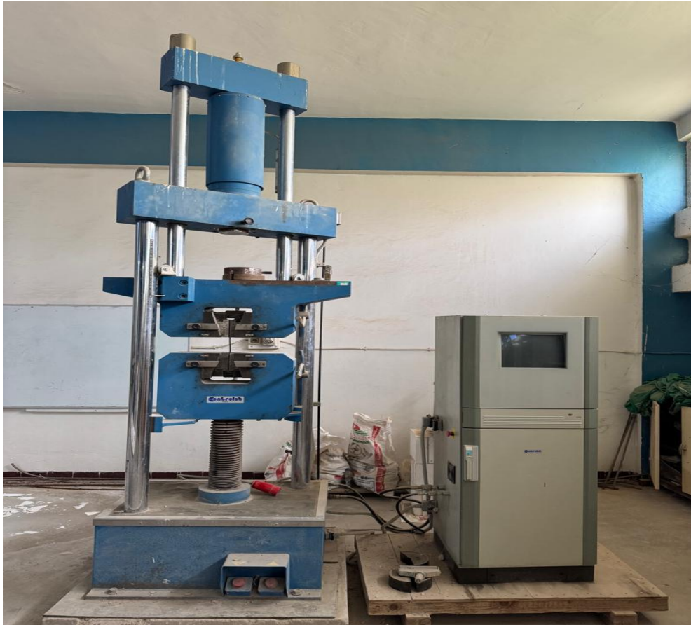
Figure 2.4 Essai de traction sur la machine Controlab 600KN au laboratoire matériaux de construction[11]
