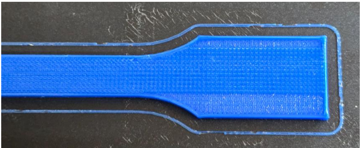
Figure 3.17 Éprouvettes avec remplissage Gyroïde
