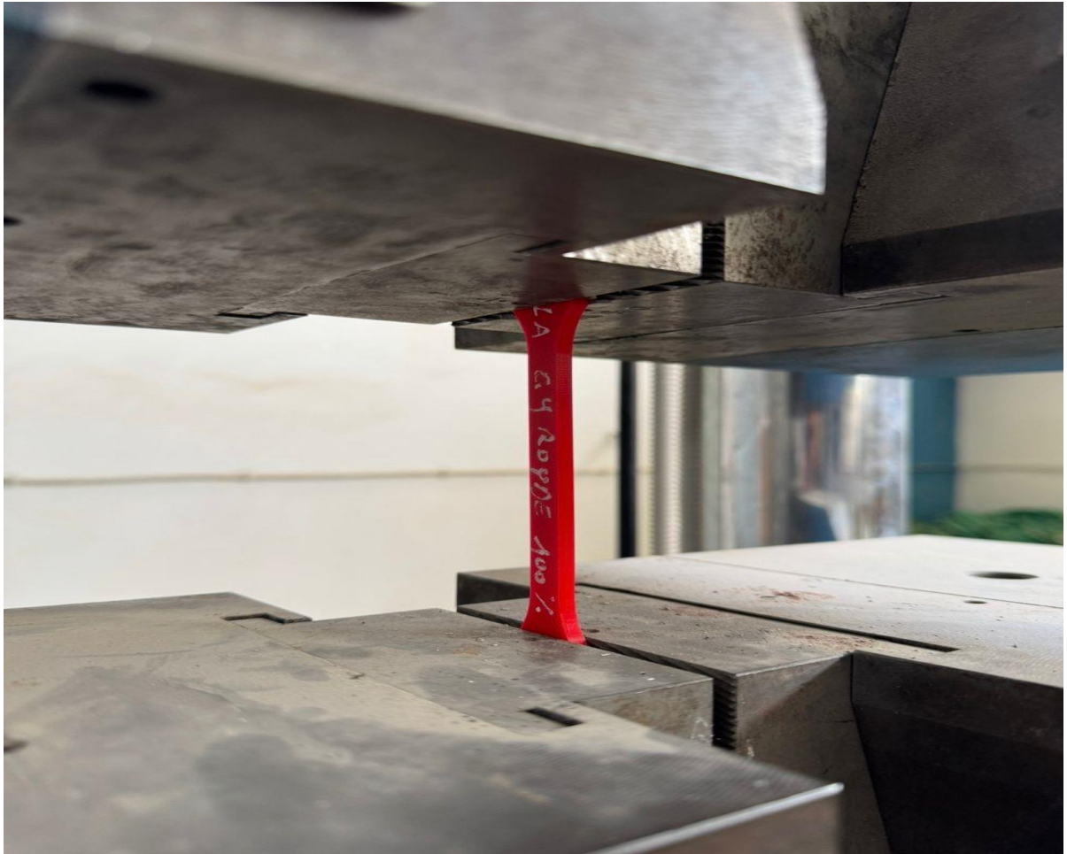
Figure 4.2 Installation de l'éprouvette dans la machine de traction Controlab
