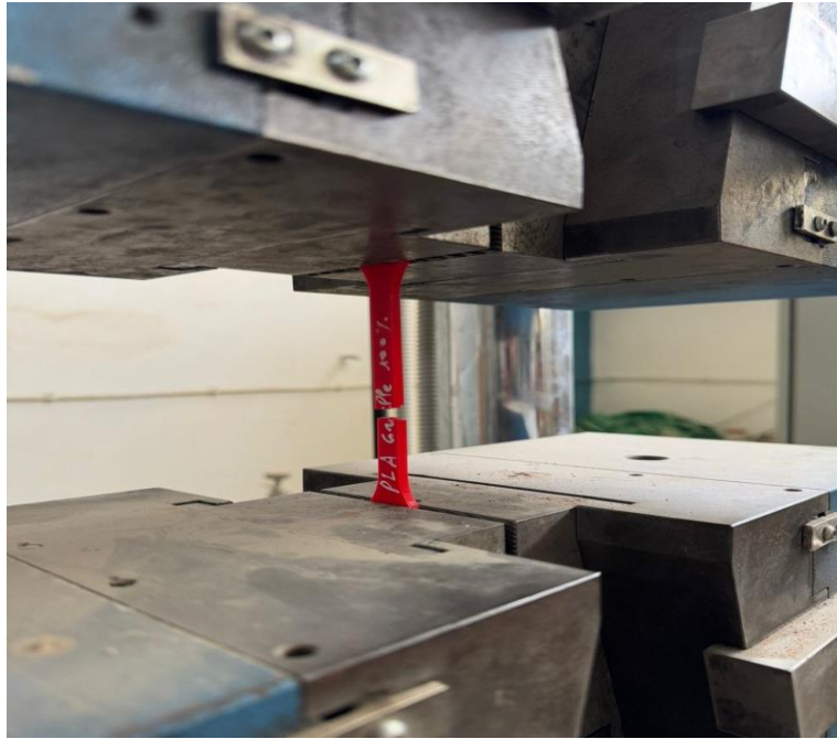
Figure 4.3 Rupture de l'éprouvette après essai de traction
