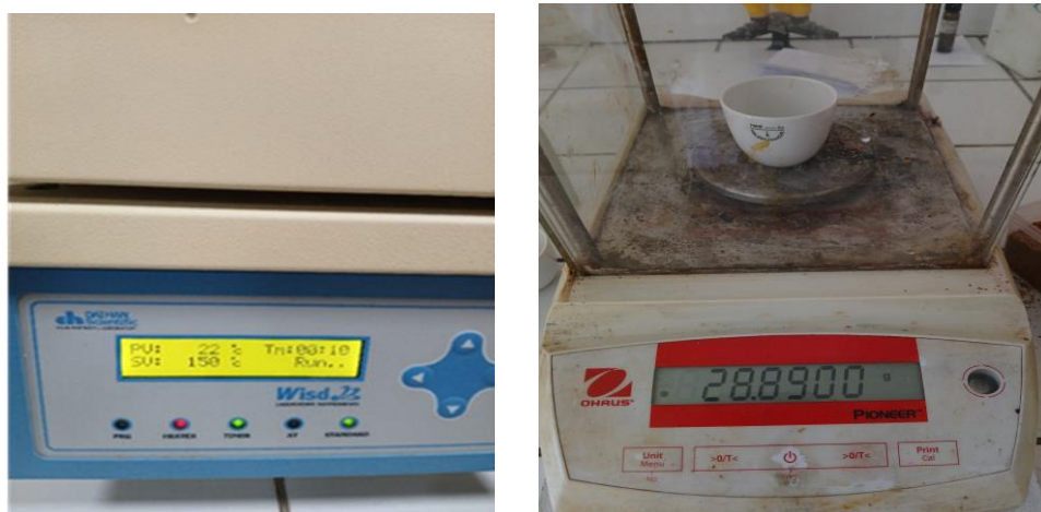
Figure 37. Four réglé à 150°C pour la décomposition thermique pendant 10 minutes (Atallah, 2026)
