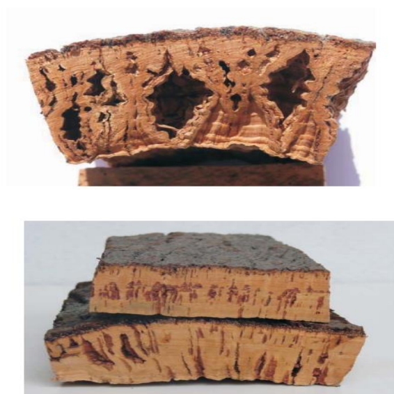
Figure 53. En haut : pores de grand diamètre remplie d'air ; en bas : liège terreux (Atallah, 2026)
