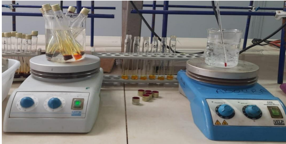
Figure 24 :Dispositif expérimental utilisé pour l'étude de la cinétique d'hydrolyse du saccharose par l'invertase immobilisée.
