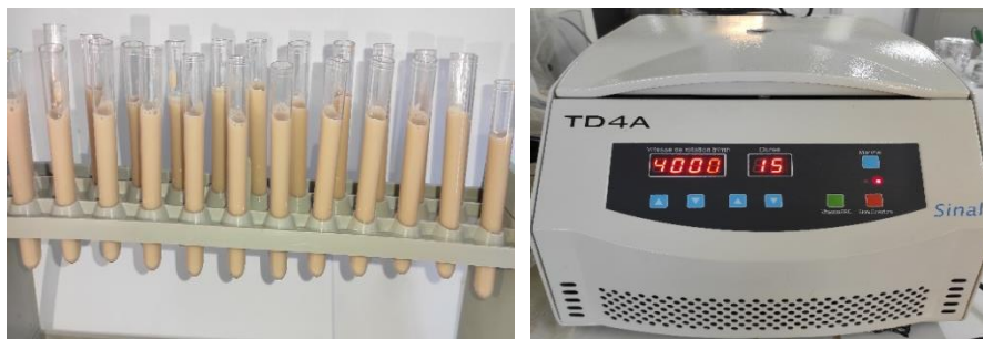
Figure 16: Préparation des échantillons avant centrifugation et réglage de la centrifugeuse à 4000 tr/min pendant 15 minutes.
