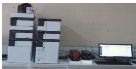
Figure II.1 : Photo de l'HPLC utilisé au laboratoire
