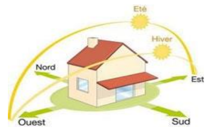
Figure 236: Forme et orientation du bâtiment. (Source : https://sites.google.com/site/maisonaenergieposit )
