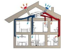
Figure 29 : Ventilation Mécanique par insufflation. (Source : http://www.cdh83.fr/details-ventilation+mechanique+par+insufflation+vmi+a+carqueiranne+dans+le+var+pres+de+hieres-243.html ).
