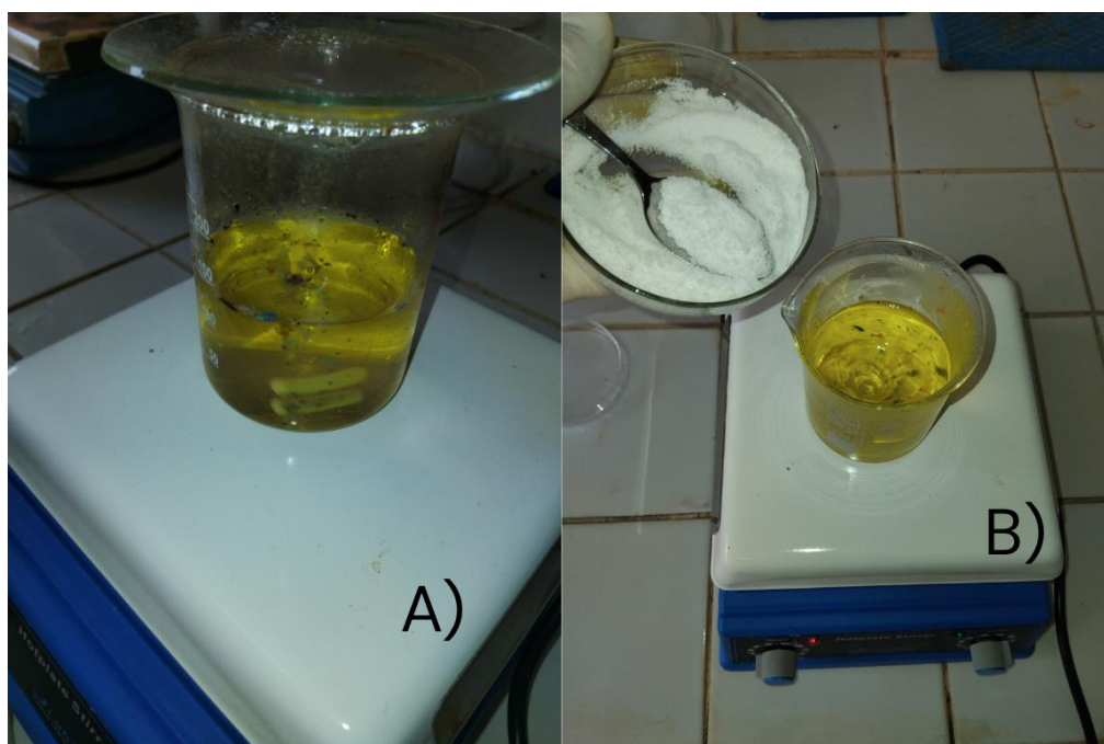
Figure 25: A) Fin de la digestion. B) Ajout du sel pour la séparation (Originale, 2025)
