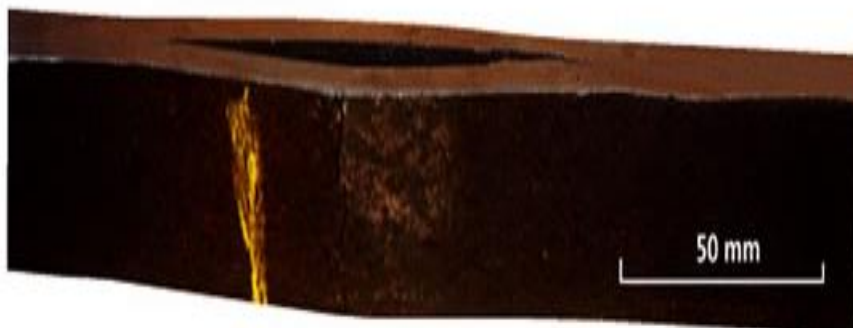
Figure II.10 : Cloquage lié à une surprotection cathodique d'une canalisation pétrole
