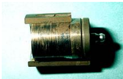
Figure II.7 : Corrosion frottement d'une pièce en acier
