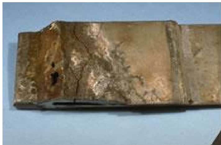
Figure II.8 : Fissuration par corrosion sous contrainte dans une structure en acier allié soudée (contraintes induites par le soudage).
