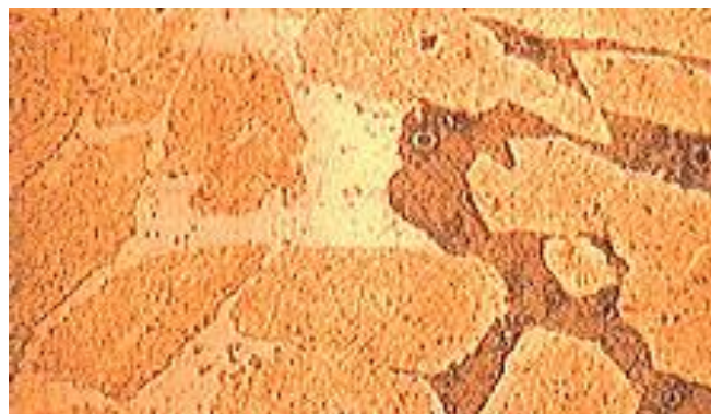
Figure II.6 : Coupe métallographique montrant une corrosion sélective d'un laiton
