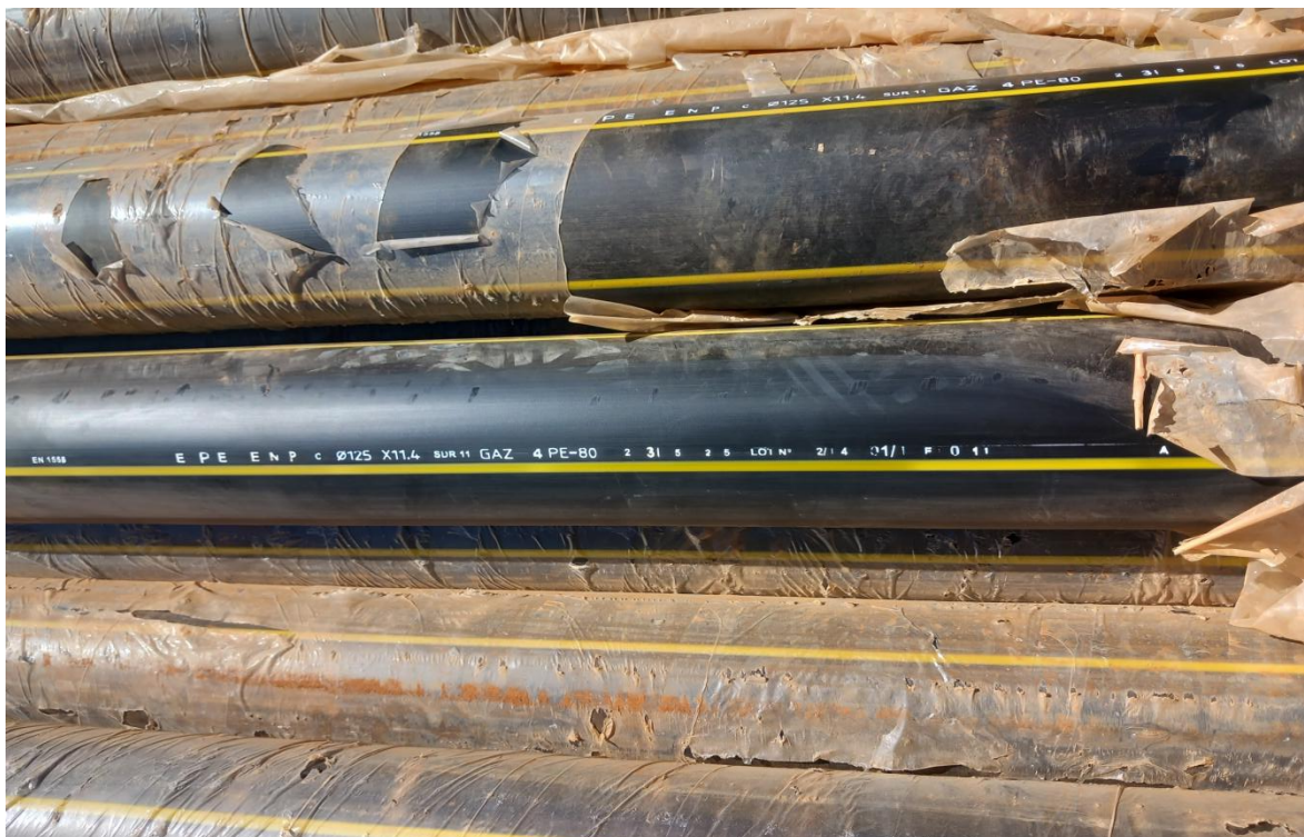
Figure III.2 : Conduites en matière PEHD
