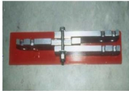
Figure 1.25 : Amortisseur boulonné encoché
