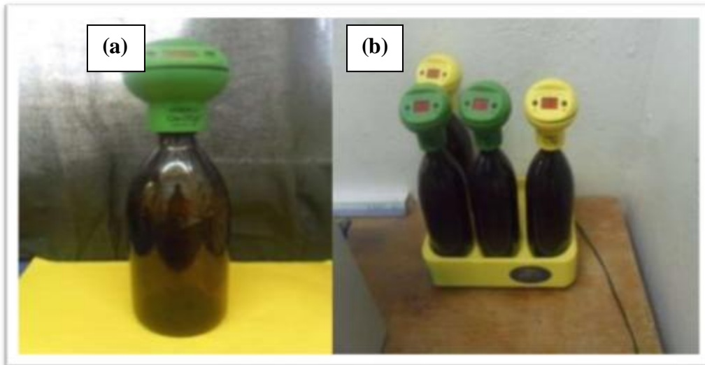
Figure .II. 9 :(a): Photo d'un flacon à DBO ,(b) : Photo du DBO mètre.
