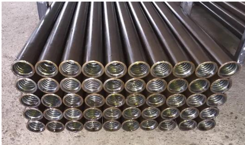
Figure 14 : Tiges en acier utilisées dans un sondage carotté
