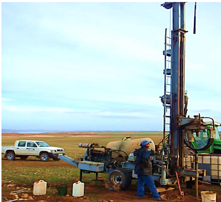
Figure 13 : Sondeuse pneumatique utilisée lors des travaux d'exploration par Knauf Oran
