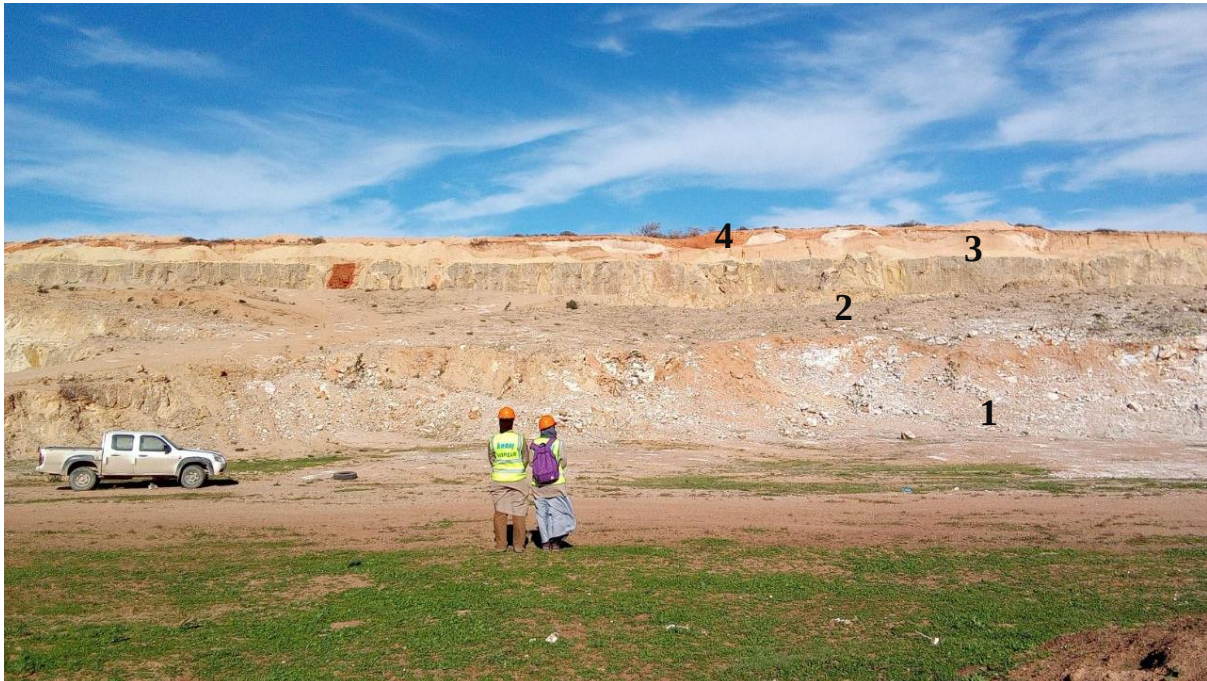
Figure 20: Photo prise de la route CW41 illustrant les principales formations géologiques affleurantes à la carrière de Kada Srar : 1 : Gypse albâtre, 2 : Gypse sélénite, 3 : Marne argileuse, 4 : Sole rouge.
