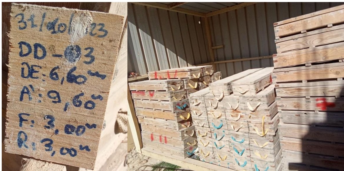
Figure 18 : étiquetage (A) et stockage (B) des carottes de sondage adoptées par la société knauf
