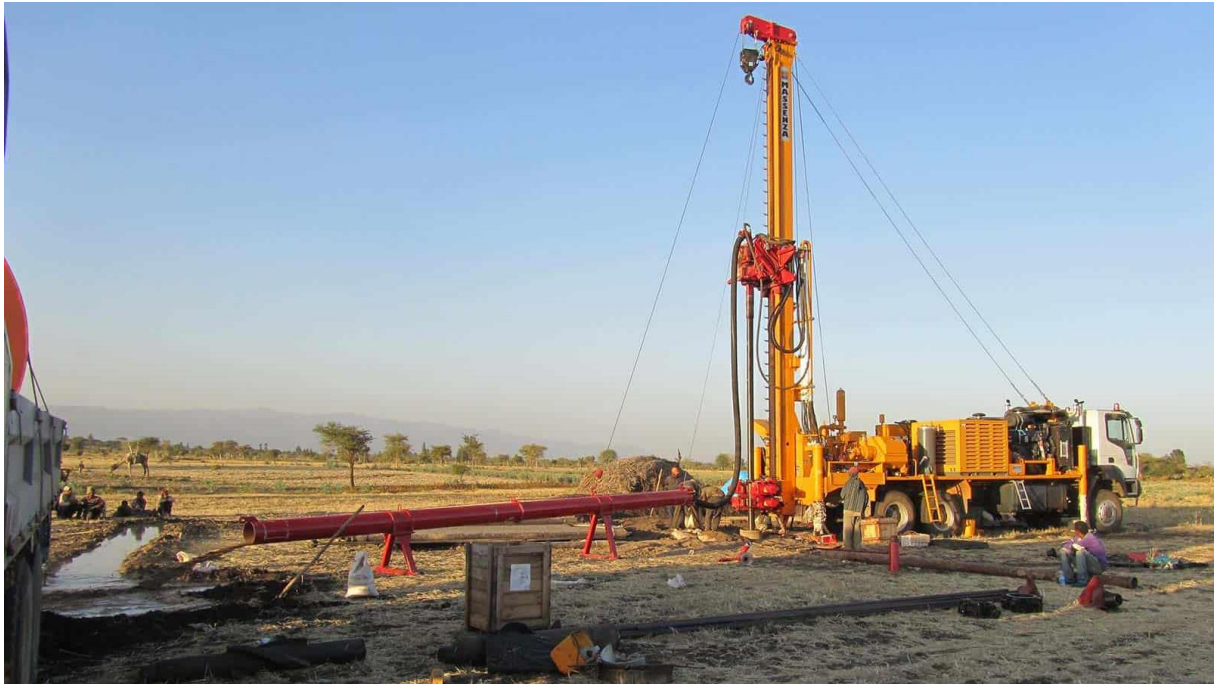
Figure 12 : Réalisation d'un sondage en circulation inverse (source internet).
