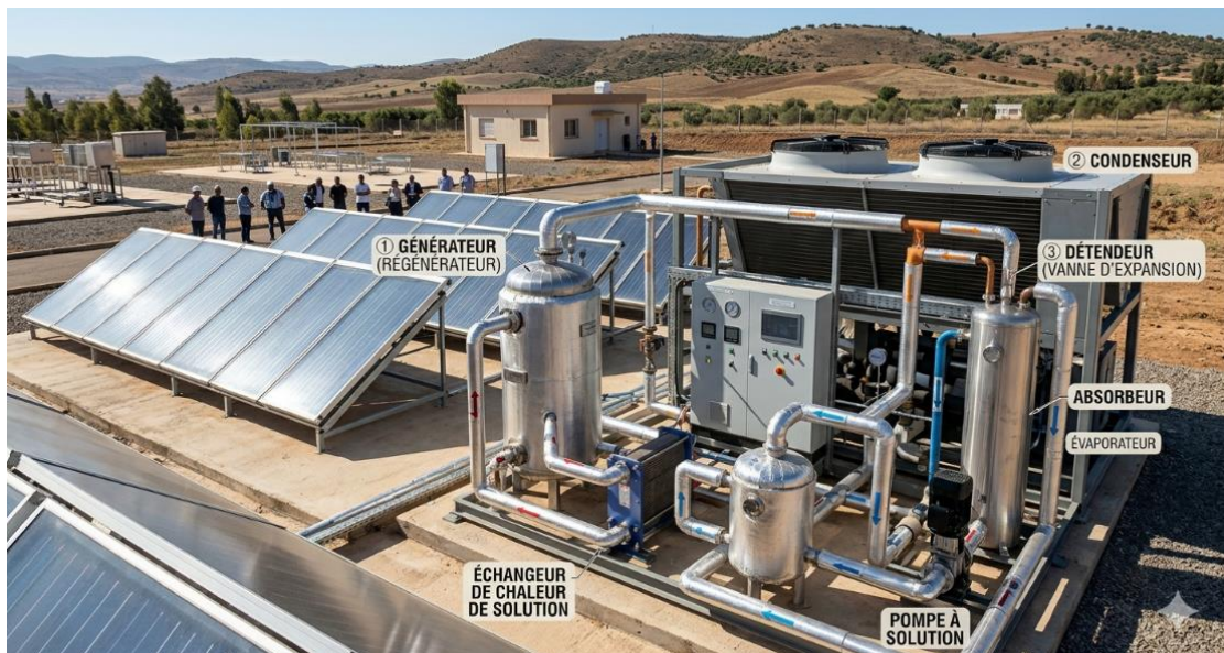
Figure III. 1 : Installation expérimentale d'un système à absorption
