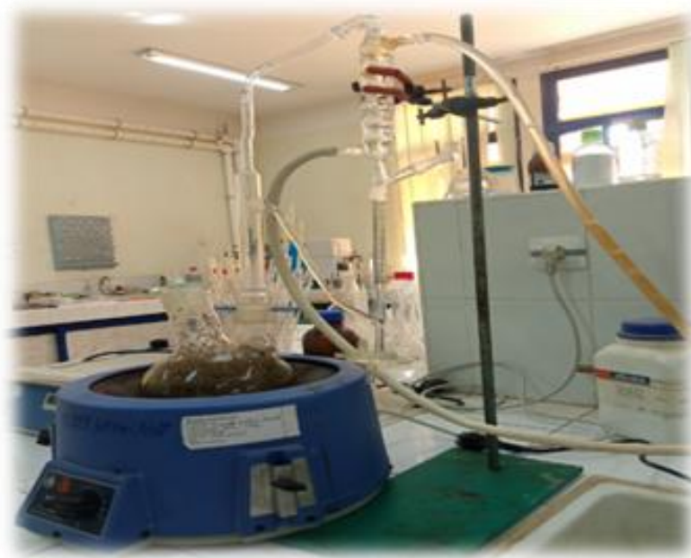
Figure 5 : Montage de l'appareil d'hydrodistillation lors de l'extraction de l'HE
