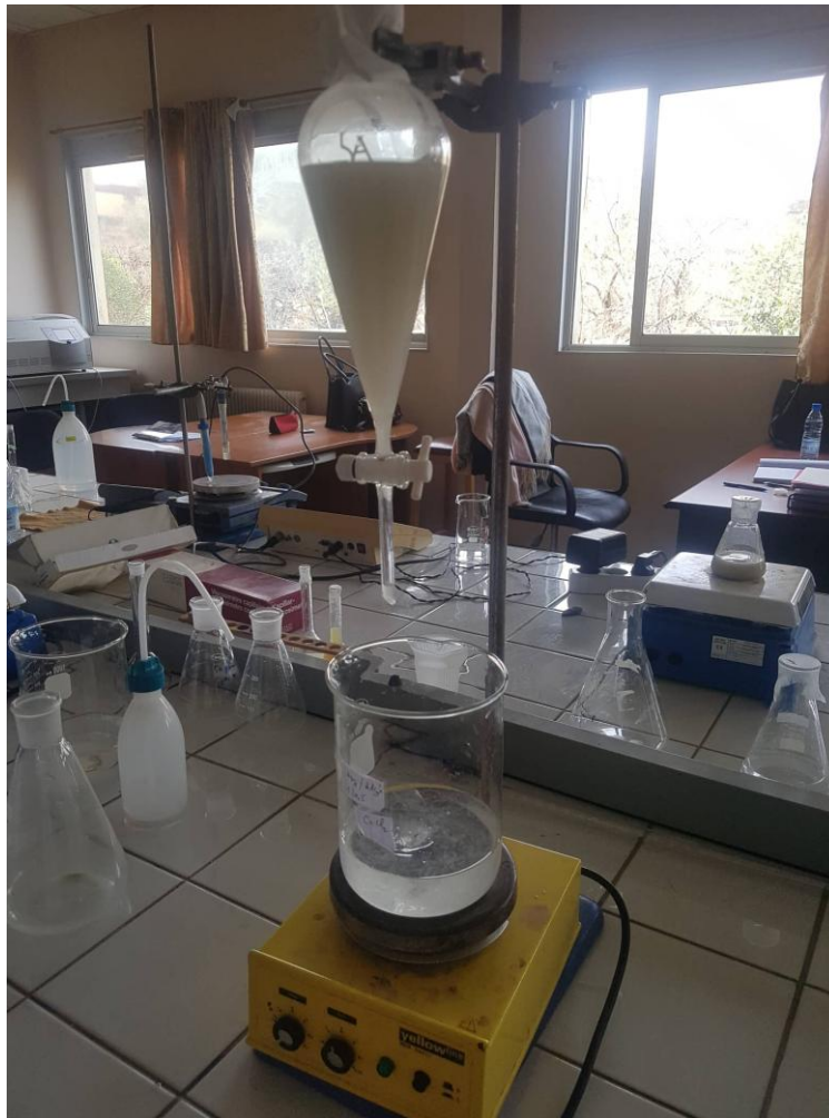
Figure 12: Précipitation de la solution d'alginate dans une solution de chlorure de calcium.
