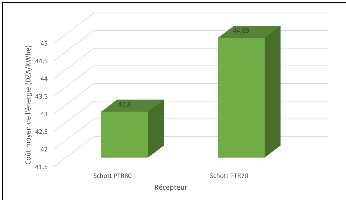
Figure 4. 25 : Cout moyen par CSP pour déférant récepteur sur la ville de Tlemcen
