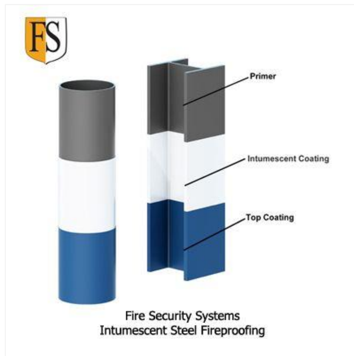
Figure IX.3 : Protection par système intumescent
