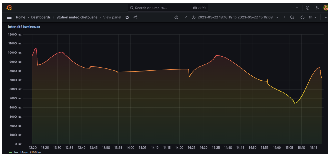
FIGURE IV.7 – Mesure de l'intensité lumineuse.
