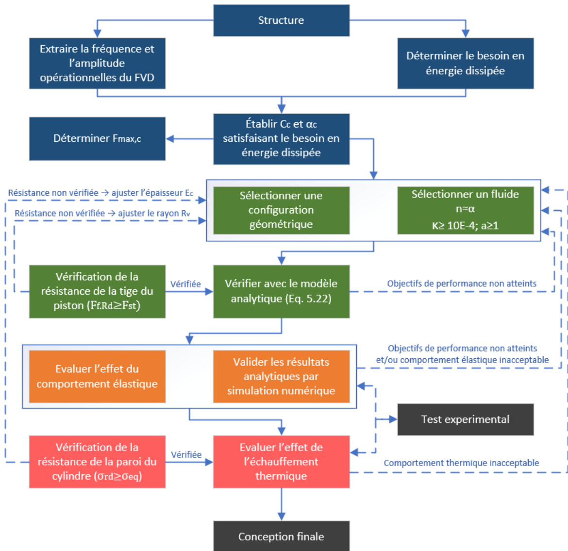
Figure 5.5. Organigramme représentant le processus de conception d'un FVD à orifice annulaire.
