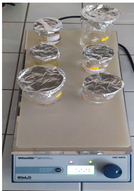
Figure IV.12 : Dispositif expérimental utilisé pour la détermination du point de charge zéro (pHzpc) des matériaux sorbants.
