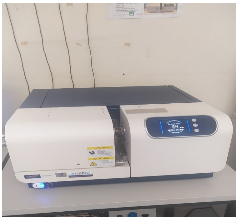
Figure IV.9 : Photo de l'Appareil ATG/DTA utilisé
