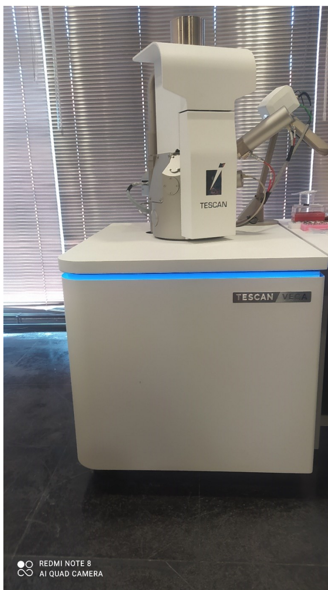
Figure IV.10 : Photo du Microscope électronique à balayage (MEB) TESCAN VEGA
