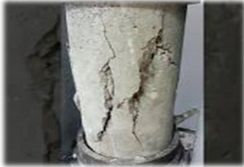
La figure 2.12. : Rupture de l'éprouvette au cours de l'essai de compression
