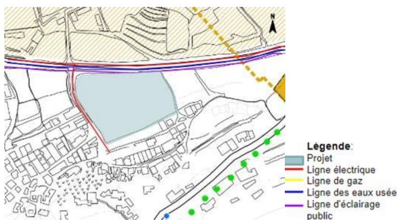
Figure 167 : réseaux d'électricité, gaz et eau potable
