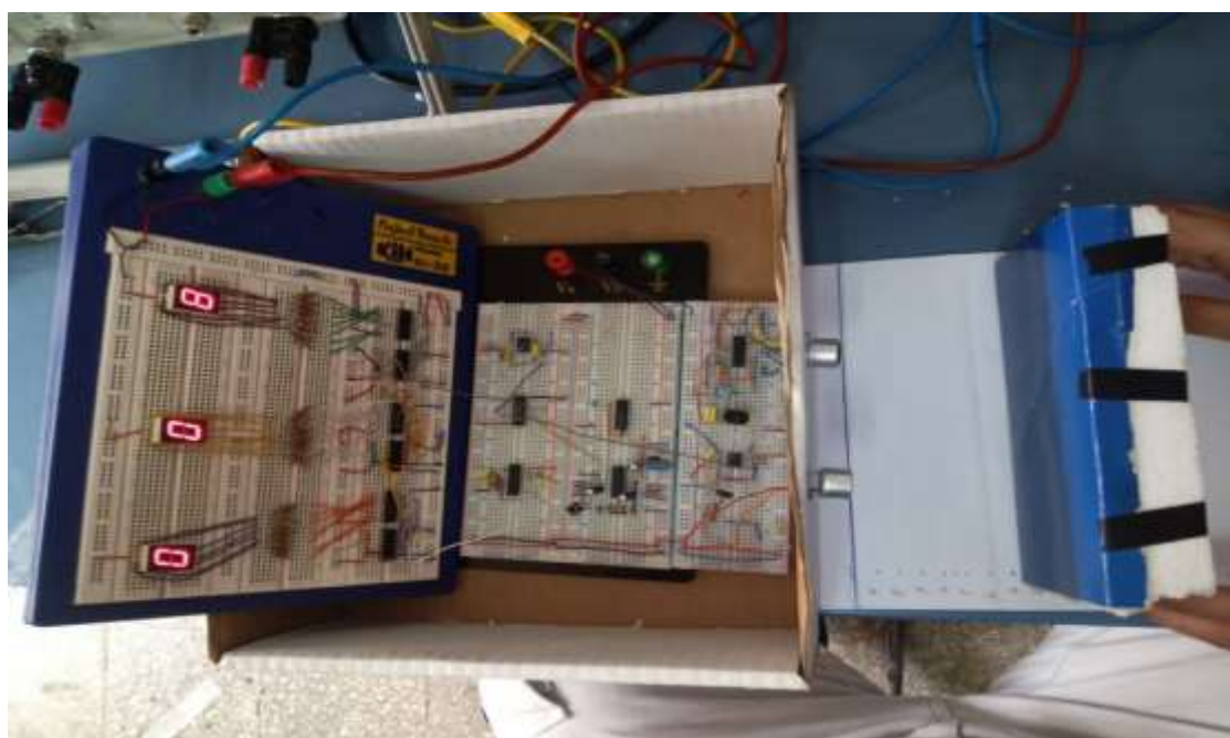
Figure III-24 Circuit Complet du télémètre à ultrason
