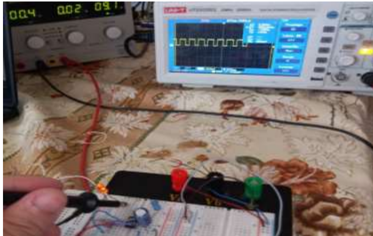
Figure III-22 Forme de signal d'horloge
