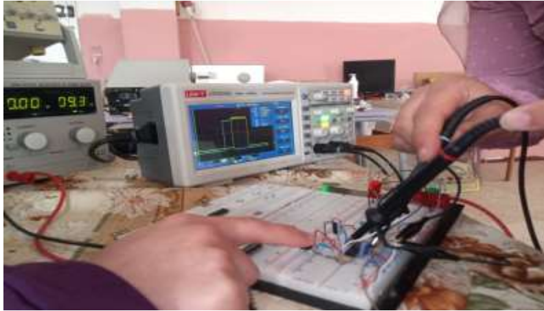
Figure III-11 Forme des signaux générés par le monostable CD4538.
