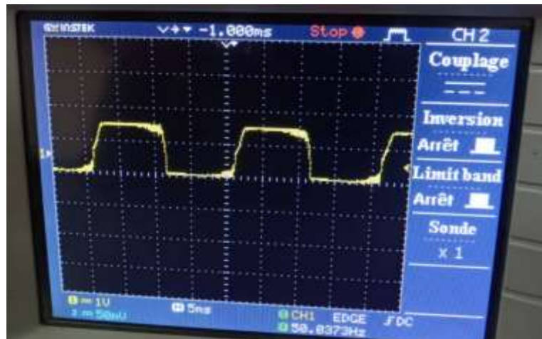
Figure III-19 Point 7 : Sortie d'AOP sélectif
