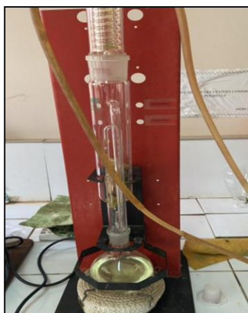
Figure 20 : Détermination teneur en lipide par le Soxhlet (Originale)
