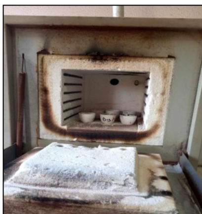
Figure 22 : Détermination de la teneur en cendres par le four à moufle (Originale)
