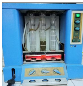
Figure 21 : Détermination des fibres par (Fibre-test) (Originale)
