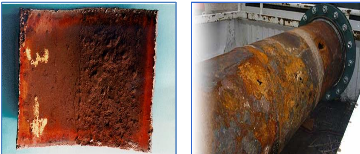
Figure I. 4 : corrosion dans le pipe. (a) :interne_(b) : externe. 2
