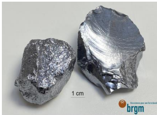
Figure II.15 : Gauche : fragment de silicium métallurgique (Pureté : 99,0 %) Droite : fragment de polysilicium (Pureté : 99,999 999 9 %)
