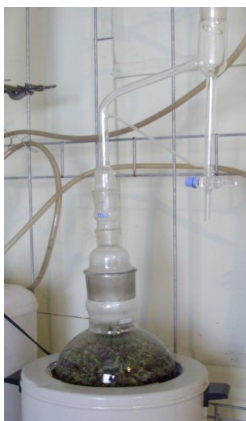
Figure 5 : Extraction des huiles essentielles par hydrodistillation (Tlemcen, 2025).
