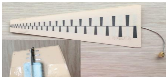
Figure I. 22. Antenne à réseau dipolaire trapézoïdal log-périodique plan [26].
