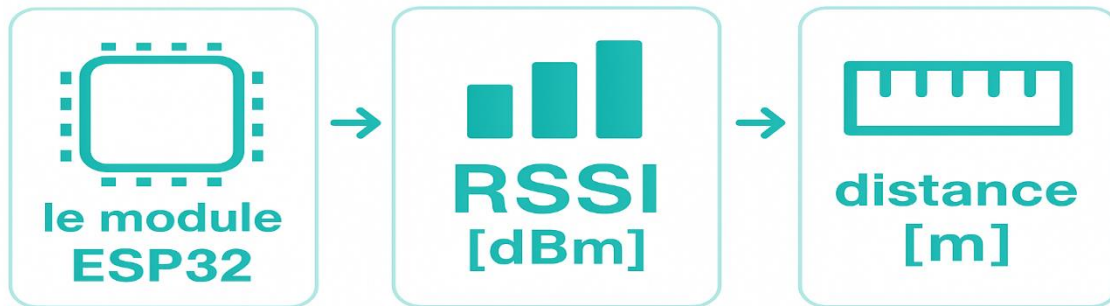
Figure III-1: Schéma De Détection Des Signaux Mobiles
