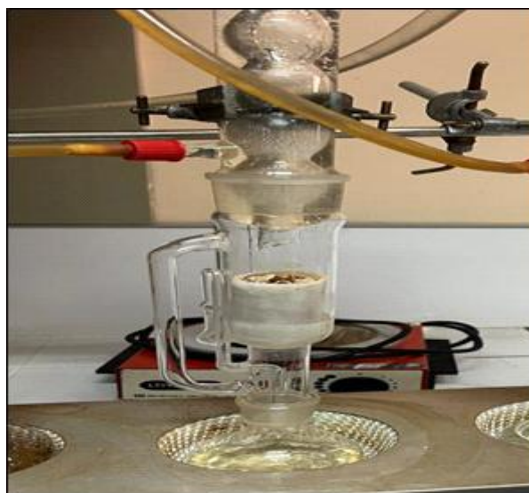
Figure 14 :Dégraissage par Soxhlet (Photo personnel , 2025).
