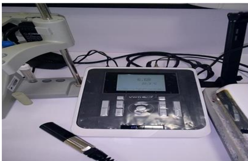
Figure V. 3: pH mètre VWR [14]
