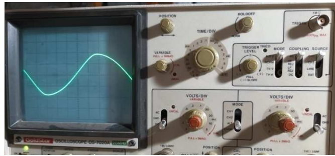
Figure 46 : Sortie d'une tension de référence (la consigne) parmi les 3 de la carte PWM.
