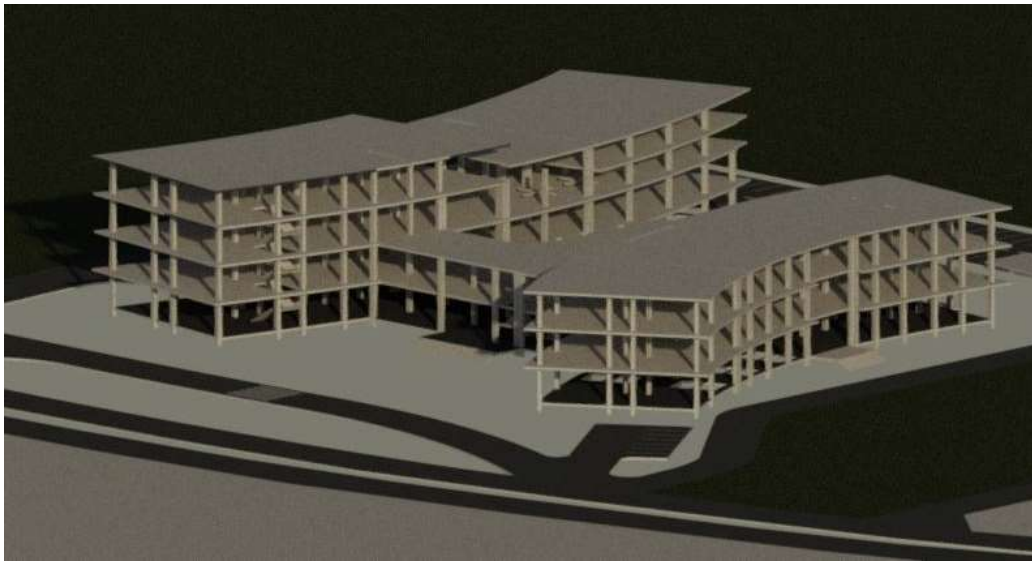
Figure 99 : Système poteau-poutre dans le projet en 3d
