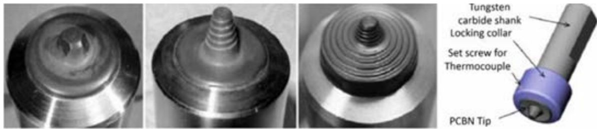
Figure 2. 7 : Caractéristiques et géométrie du système d'outils PCBN.
