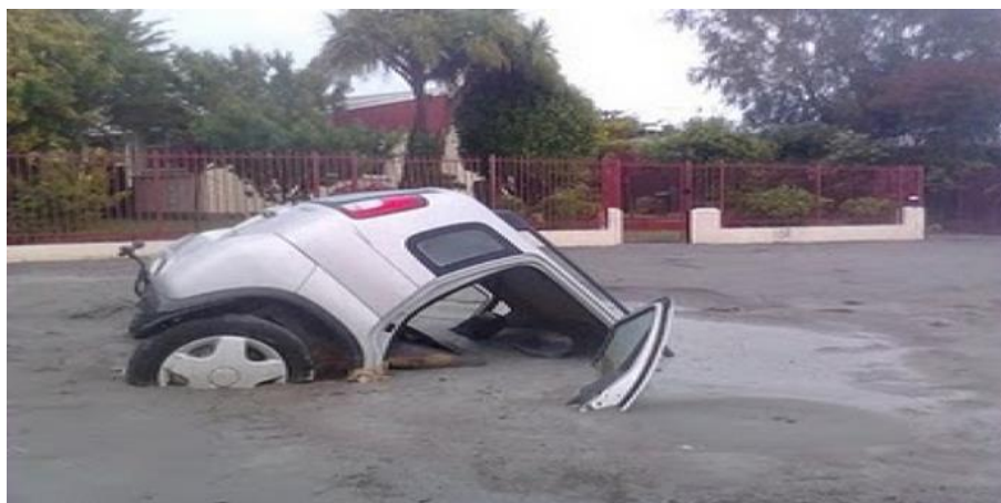
Figure 2.8 : Un véhicule enlisé dans la liquéfaction, après le tremblement de terre à Christchurch, New Zealand (2011)
