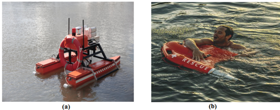
FIG. 1.11 : USV de recherche et sauvetage : (a) USV des garde-côtes, (b) planche de sauvetage motorisée.
