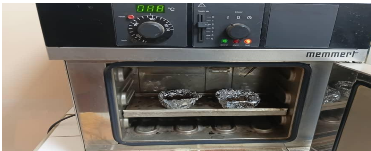
Figure 3: Séchage des échantillons dans une étuve à 105 °C pendant 24 heures
