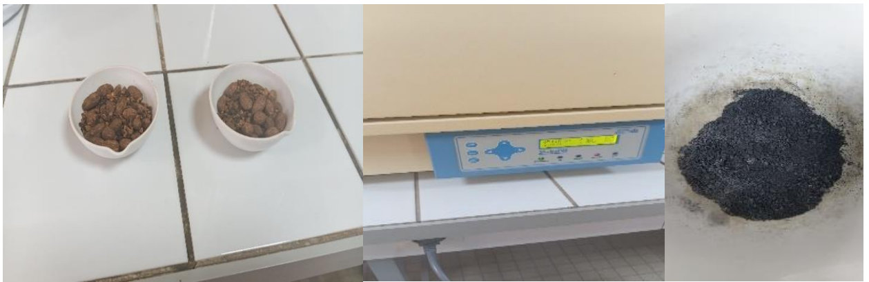
Figure 2 :les etapes de pyrolyse utilisé pour la production du biochar à partir du grignon d'olive.
