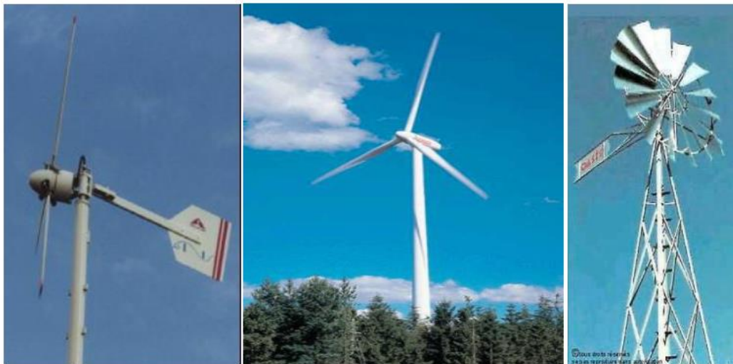
Figure 1.13 Eoliennes à axe horizontal [26].
