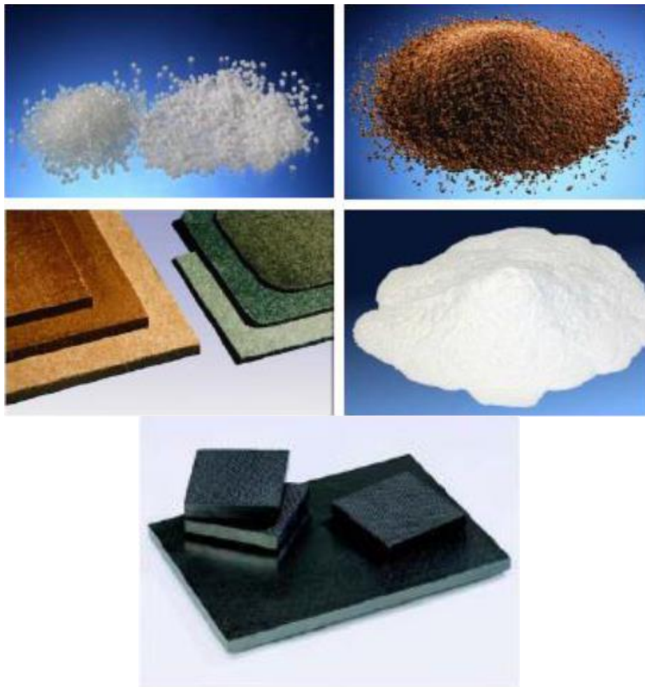
Figure 2-124 : Illustration de MCP micro-encapsulés (sources : en haut Rubi-therm™, en bas Climator®)
