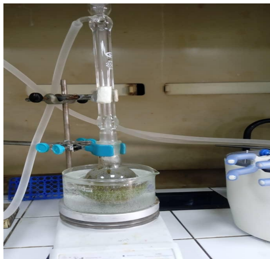
Figure 09 : Méthode d'extraction par décoction.
